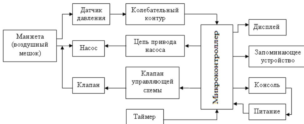
Рис. 3. Структурная схема прототипа
